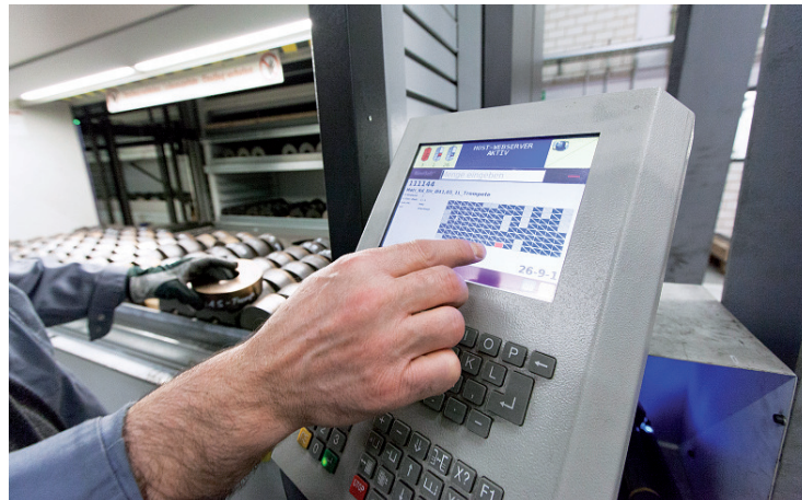
Bild 2 Mit Hilfe des Touchscreen-Terminals können Lagerplätze auf dem Container fixiert werden.
