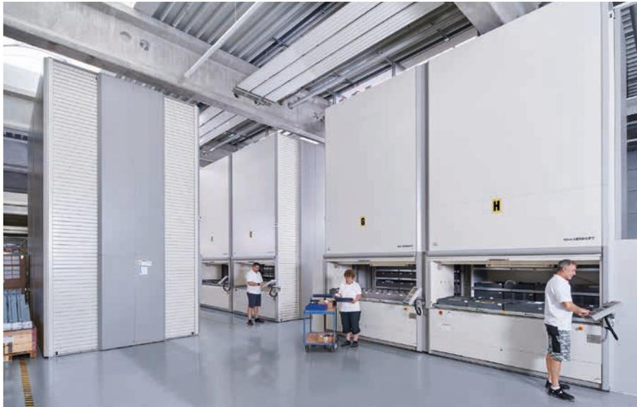
▲ Sechs Vertikallifte in High-Speed-Ausführung von Hänel sorgen im Kommissionierlager der Storz Medical AG für eine noch schnellere Abwicklung von Kundenbestellungen (Fotos: Marks)
